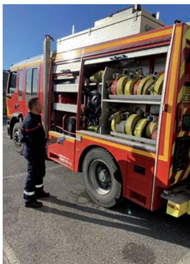
8h15 : Vérification du matériel des engins d'incendie et essai des pompes incendie par le conducteur poids lourd de la garde.
